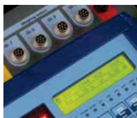
DISPLAY LCD RETROILLUMINATO in grado di visualizzare il peso di ogni piattaforma ed il baricentro.
