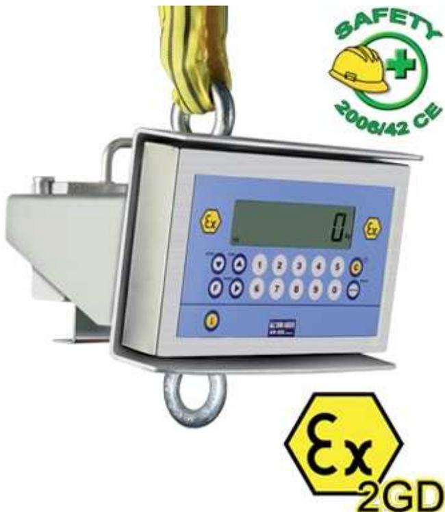
Dinamometri per applicazioni di pesatura in zone ATEX classificate a rischio di esplosione (ZONA 1 e 21, 2 e 22) con modo di protezione secondo Ex II 2GD IIC T4 T197°C X. Struttura completamente in acciaio INOX, con grado di protezione IP68. INGOMBRO VERTICALE RIDOTTO per lo sfruttamento ottimale dei mezzi di sollevamento.
